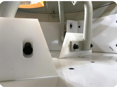
高分子PE材质 衬板/叶片 PE Liner / Mixing Blade
